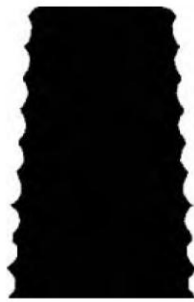
Εικόνα 3.10: Τυπικό προφίλ σε υμένιο φωτοευαίσθητου υλικού και το αντίστοιχο τραπέζιο.
