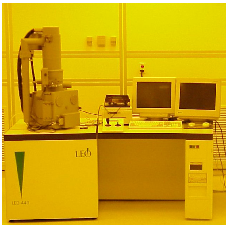
Σχήμα 20 Ηλεκτρονικό Μικροσκόπιο Σάρωσης. Μοντέλο Leo 440 (Zeiss-Leica).
