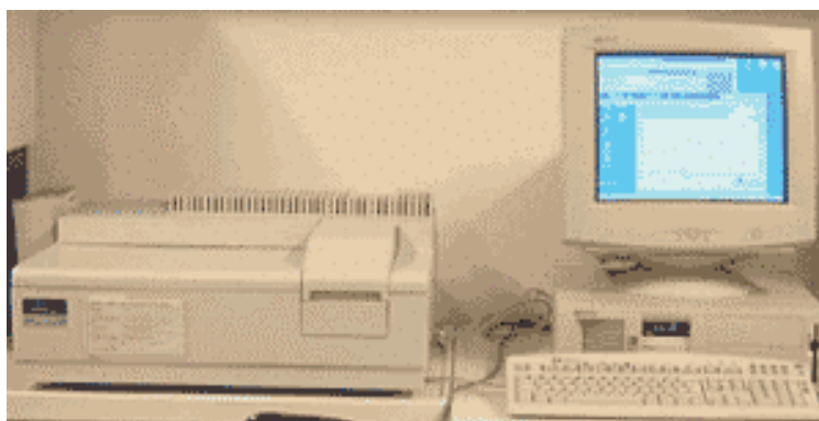
Σχήμα 14 Φασματοφωτόμετρο UV-Vis. Μοντέλο Lambda 40 Perkin Elmer.
