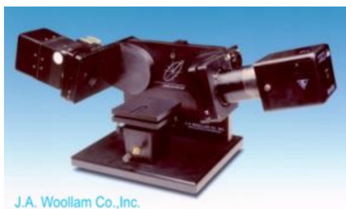
Σχήμα 9 Φασματοσκοπικό ελλειψόμετρο που καλύπτει την περιοχή 245-1000 nm (470 μήκη κύματος)
