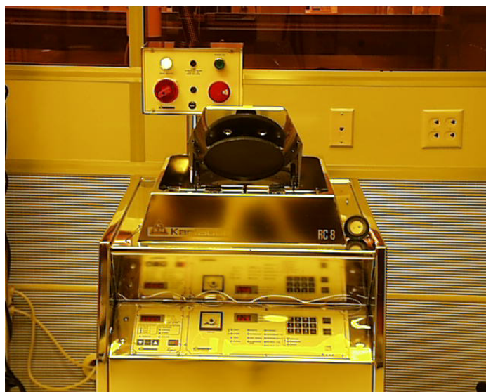
Σχήμα 18 Περιστροφικός επιστρωτής. Μοντέλο Karl Suss RC-8
