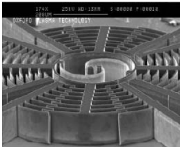
Εικόνα 3.12 Ένας μικρομηχανικός αισθητήρας. Οι ομαλές επιφάνειες και οι κάθετες δομές βελτιώνουν τη μηχανική σταθερότητα του αισθητήρα
