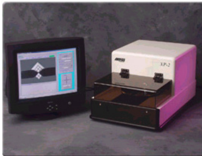
Σχήμα 17 Προφιλόμετρο ακίδας. Μοντέλο XP 2™.
