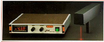
Σχήμα 3 Σύστημα λέιζερ He-Ne που χρησιμοποιείται για τη συμβολομετρία στον εγχάρακτη πλάσματος NE330 του Ινστιτούτου Μικροηλεκτρονικής
