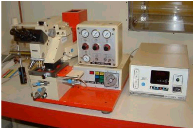
Σχήμα 1 Ευθυγραμμιστής μασκών KARL SUSS MJB 3
