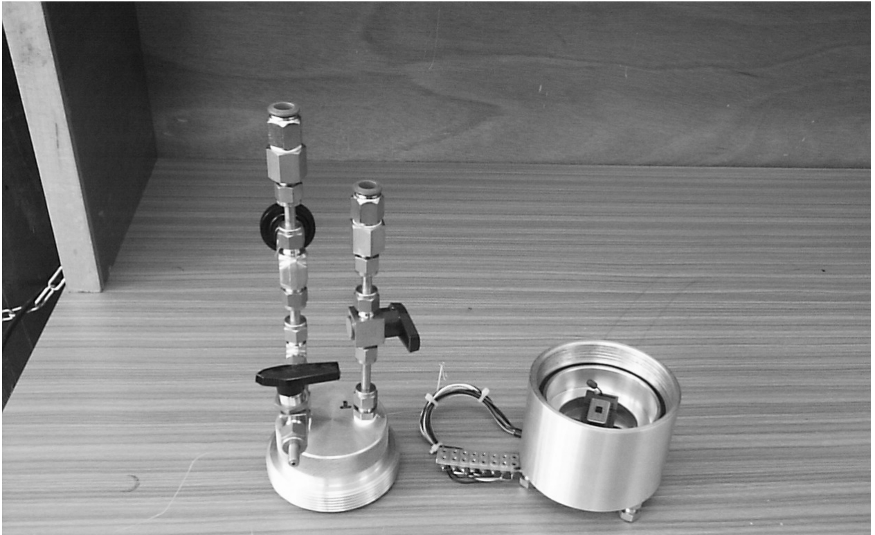
Φωτο 4.3 Η κυψελίδα στην οποία τοποθετήθηκαν οι αισθητήρες, για τον χαρακτηρισμό τους.
