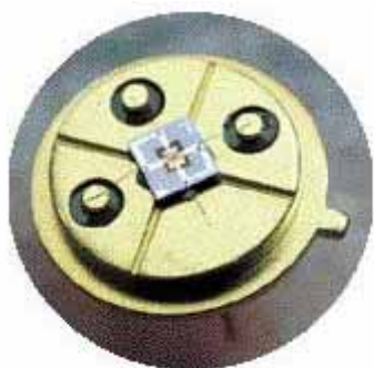
Φωτο 1.3 Μικροθερμαντική πλάκα με καταλυτικό υλικό, κατασκευασμένη στο κέντρο μιας ψηφίδας Si.
